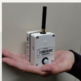
センサーは手に乗るくらいの大きさです。本体下部の白い部分が赤外線センサーです。
